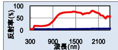
可視光領域（380-780nm）は反射させず、近赤外線領域（780nm以上）の反射率を大きくしています
