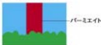
パーミエイトは、当初、**金属溶射用の封孔剤として開発しましたが、その特性である微細孔への浸透・硬化、基材への強付着力、及び無機系ポリマーの特徴である高耐候性等を活かし、多くの分野で活用していただけます。**
