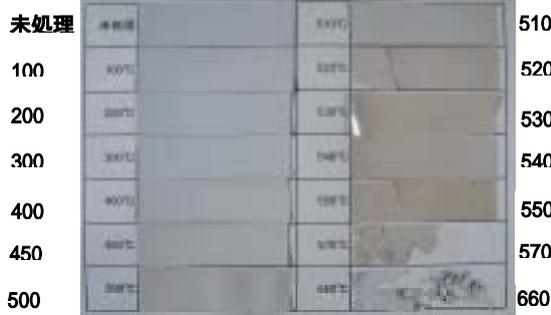
PETフィルムにパ-ミエイトをフィルムアプリケーターにて塗布し、室温で1週間硬化養生後、50\*15mm\*14枚に切断。このフィルムを電気炉で加熱し、各温度で一枚毎に取り出し評価。
