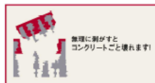
図-25 塗膜の剥離
